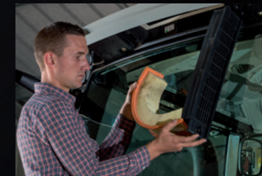
Il filtro dell'aria della cabina può essere rimosso e pulito facilmente.
