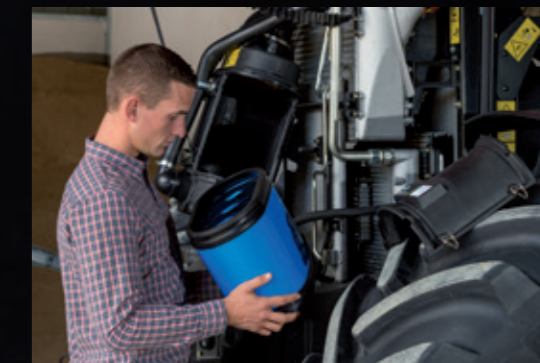
Il sistema di raffreddamento è realizzato in modo intelligente ed è facilmente accessibile per eseguirne la pulizia e la manutenzione. Il 90% della polvere viene rimosso grazie all'aspirazione prodotta dalla ventola di raffreddamento. Altrettanto facili sono l'accesso e la pulizia del filtro dell'aria del motore.
