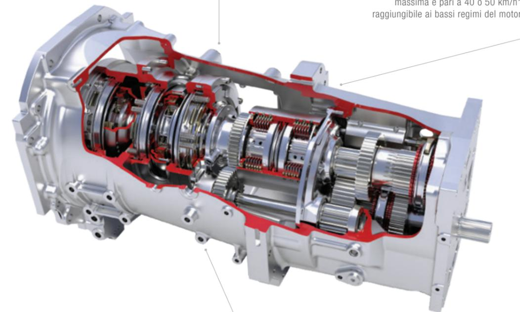
Dyna-6 Super Eco offre sei marce in Powershift e quattro gamme per la massima facilità di gestione sul campo e sulla strada. Un totale di 24 velocità in entrambe le direzioni significa che è disponibile una velocità adatta praticamente per qualsiasi operazione, mentre la velocità di trasporto massima è pari a 40 o 50 km/h\* e raggiungibile ai bassi regimi del motore.
