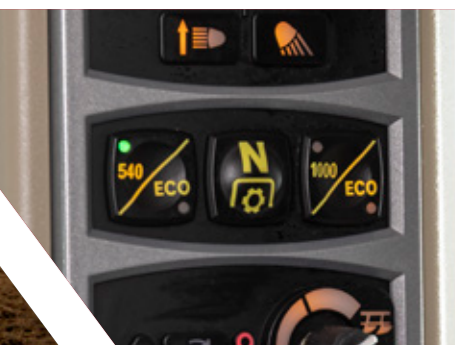
Selezione elettroidraulica della velocità della PTO
