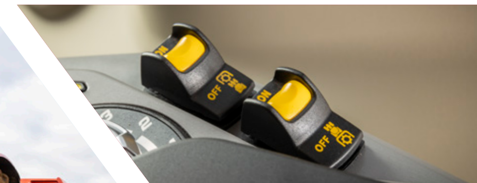
Selezione elettroidraulica della velocità della PTO
