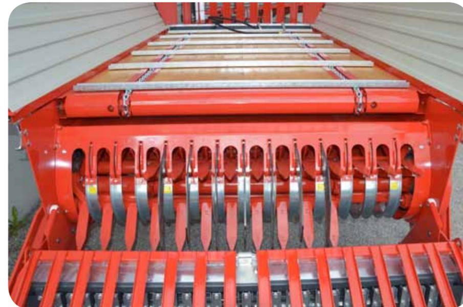
Das Förderaggregat ist auf schnelles Laden, mit bis zu 13 auf zwei Ebenen angeordneten Messern, ausgelegt. Die vier sich überlappenden Förder-schwingen bewirken einen runden Lauf und ein schnelles Fahr-und Ladetempo.
