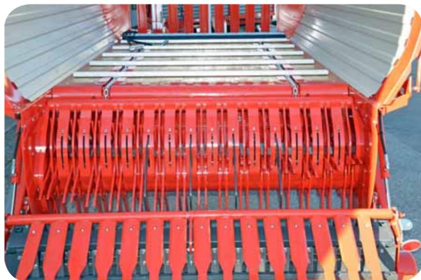
Das Ladeaggregat mit seinen 14 Schneidstellen und dem wartungsarmen, sowie robusten Laderotor mit spiralförmiger Zinkenordnung garantieren eine effiziente (nur 650 Nm) und energieschonende Futteraufnahme. Alle Zinken und Abstreifer sind aus hochverschleißfestem Stahl und sind äußerst laufruhig sowie wartungsarm (nur 2 Schmiernippel). Der ALW3 ist für Allradlenkung ausgelegt.
