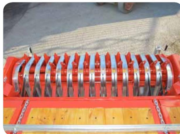
Die geschobene Pick-up, mit extrabreiten Tastrollen, eine Messerbruchsicherung und das zurückschwenkbare Förderorgan mit Abladedosiereffekt, sind die prägnanten Punkte, welche den ALW2 beschreiben. Zudem lässt sich die Rückwand von der Kabine aus, auf Knopfdruck, öffnen und schließen und wird automatisch verriegelt.
