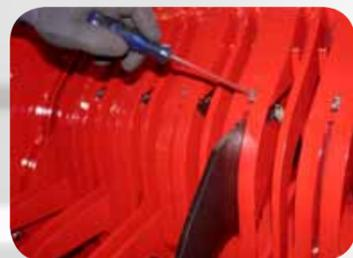
Die 14 gleichen Messer, welche in einer Ebene angeordnet sind, ermöglichen eine ideale Schnittqualität mit einer theoretischen Schnittlänge von 11cm bei 56 Schneidphasen pro Umdrehung (14 Messer mal 4 Zinken). Jedes Messer mit 8mm Stärke ist einzeln gesteckt und lässt sich bequem im Stehen herausnehmen.
