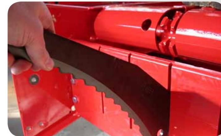
Der GRUBER ALW2 ist der einzige Aufbau-ladewagen mit Einzelmessersicherung ! (Federsicherung)
