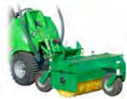
Die AVANT Kehrmaschine ist ein exzellentes Anbaugerät zum Kehren überall da, wo eine Kehrgutaufnahme nicht erforderlich ist. Die leistungsstarke Bürste kehrt den Untergrund auch bei starker Verschmutzung in einem Arbeitsgang. Der Schwenkbereich ist manuell oder hydraulisch (Option) einstellbar. Die Kehrhöhe wird durch Abstandsringe (10 mm) an den Stützrädern eingestellt.
